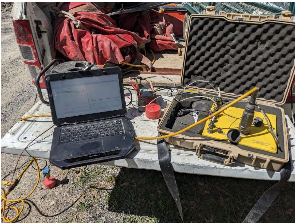
Figura 10 – Sismografo Daq Link IV in sito di prova
